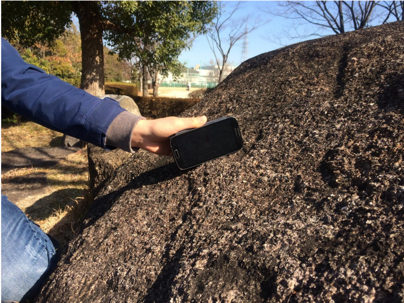
傾斜角度 (Angle of Dip) の測定方法
