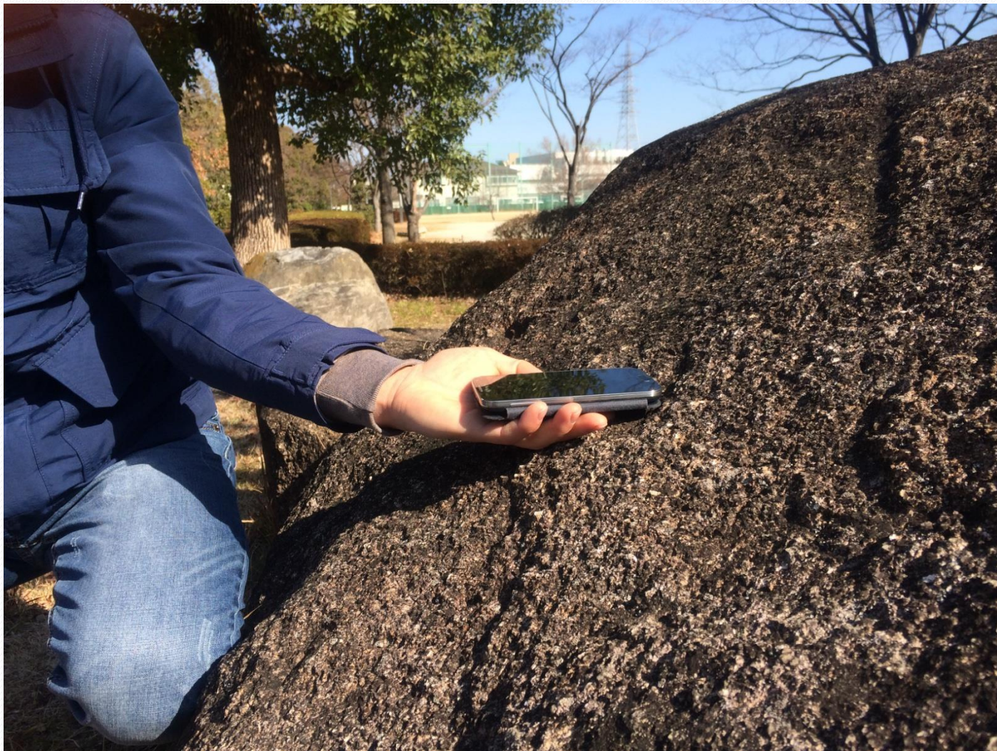
傾斜 (Dip) の測定方法
