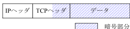
図4 従来置換方式の packets フォーマット (TCP の場合) Fig. 4 Packet format of existent replace system (case of TCP).
