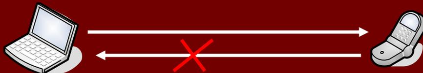
障害物,電波強度の関係で双方向通信ができない状態のリンク
